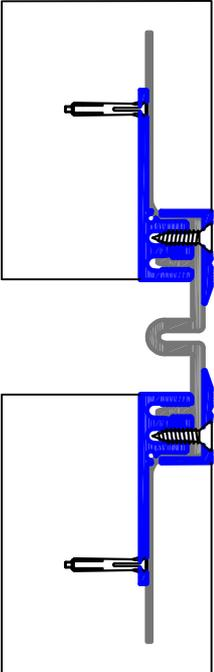
**ТИПЫ ОБВОДА ГИДРОИЗОЛЯЦИИ (материал - ПВХ-П)**
